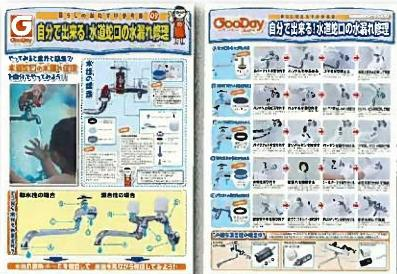
また、作業開始時は水道元栓を自分の部屋のものか確認した上、完全に閉めます。(集合住宅の場合は玄関横のパイプスペース内にあります)
